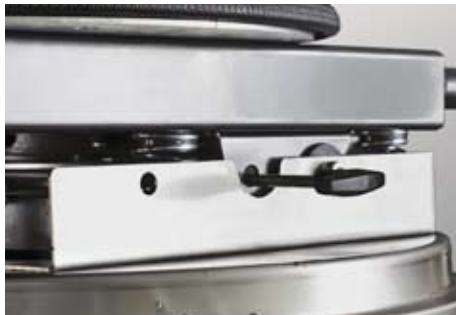
Asta invertitore di flusso pulizia filtro in automatico Circulation reverser staff automatic filter cleaning
